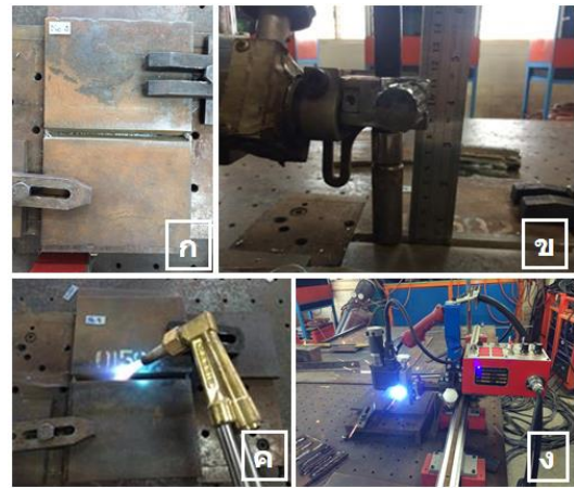
รูปที่ 2 การเตรียมเชื่อมชิ้นงานทดสอบตามสภาวะการเชื่อมต่าง ๆ
