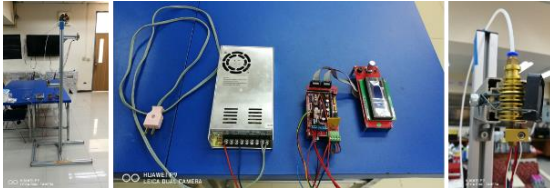
รูปที่ 2 เครื่องขึ้นรูปเส้นใย จากระบบอัตโนมัติเครื่องพิมพ์ 3 มิติ
