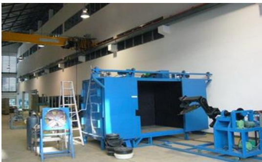
รูปที่ 2 เครื่องขึ้นรูปแบบหมุนชนิด Shuttle-Style
