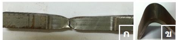
รูปที่ 6 ลักษณะการฉีกขาดและเสียรูปของชิ้นงานเชื่อมทดสอบ
