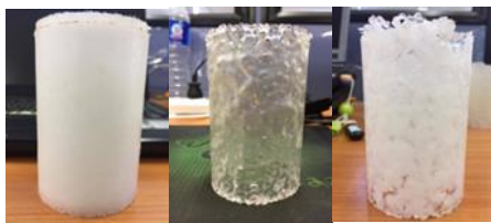
รูปที่ 6 ชิ้นงานหลังการขึ้นรูปด้วยเครื่องทดสอบการไหลแบบหมุนแกนเดียวของ neat LLDPE, neat EVA และ LLDPE/EVA ผสม ในอัตราส่วนผสม 50/50 (จากซ้ายไปขวาตามลำดับ)
