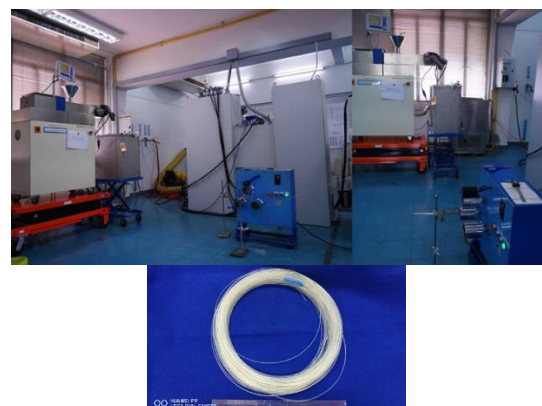
รูปที่ 5 เครื่องขึ้นรูปเส้นใย 3 มิติ และเส้นพลาสติก 3 มิติ (PLA) ที่ขึ้นรูปได้
