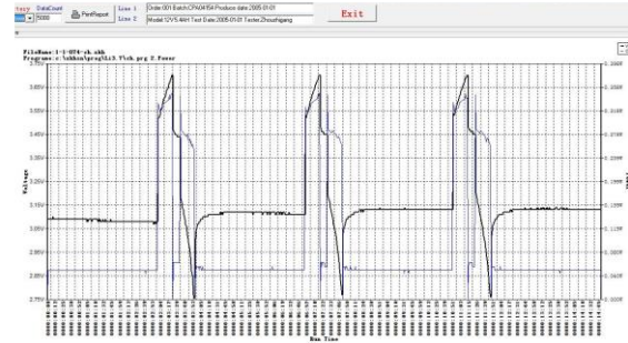
รูปที่ 10 กราฟการทดสอบการอัดประจุและคายประจุแบบต่อเนื่องที่กระแส 0.1 A
