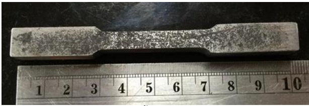
รูปที่ 4 การเตรียมชิ้นงานทดสอบด้วยแรงดึง
