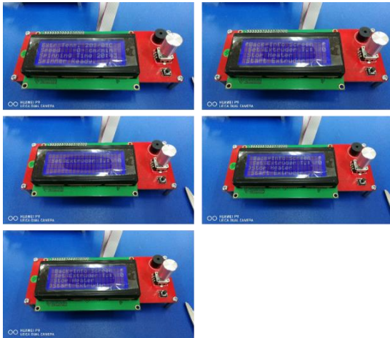
รูปที่ 3 การปรับตั้งตัวแปรในการขึ้นรูปเส้นใย
