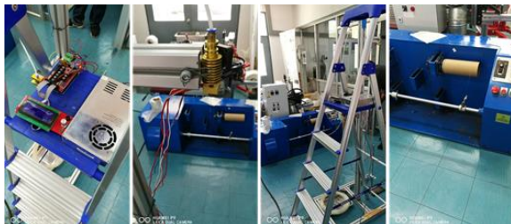
รูปที่ 4 การขึ้นรูปเส้นใยจากระบบการอัดรีดเครื่อง 3 มิติ
